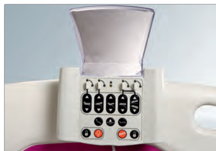
Центральная панель управления (supervisor)
