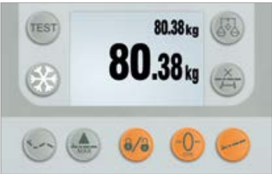
Встроенная система взвешивания Предлагается только с панелями управления WL-99.41 и WL-99.61. Система позволяет определять вес пациента и сигнализирует о покидании пациентом кровати
